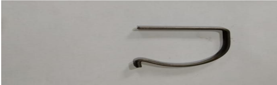
Gambar 4.10 Proses bending tahap 3 Guide Cable A
