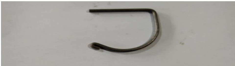
Gambar 4.11 Proses bending tahap 4 Guide Cable A
