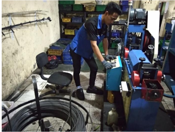
Gambar 4.7 Coil dalam proses pelurusan dan pemotongan
