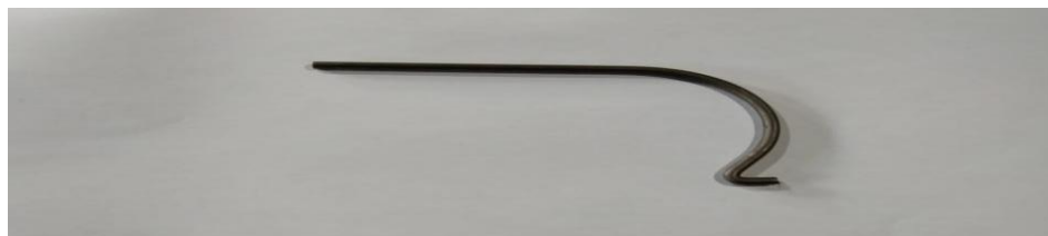
Gambar 4.9 Proses bending tahap 2 Guide Cable A
