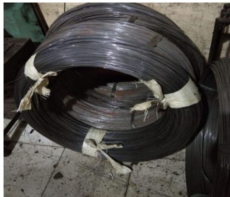
Gambar 4.6 Coil sebelum diluruskan dan dipotong
