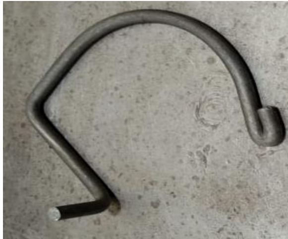
Gambar 4.12 Proses bending tahap 5 Guide Cable A
