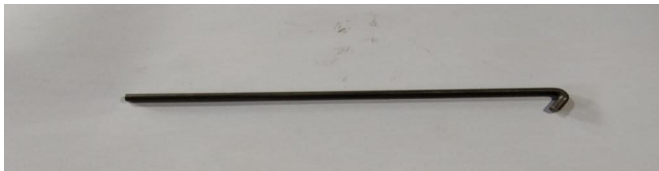
Gambar 4.8 Proses bending tahap 1 Guide Cable A
