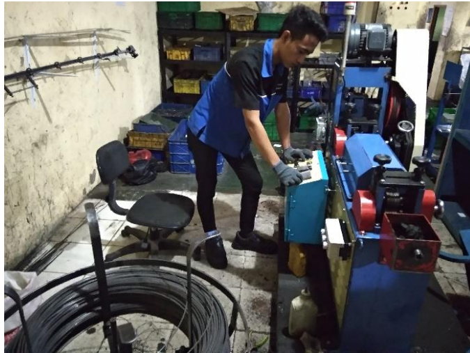
Gambar 4.6. Proses Meluruskan dan Pemotongan Coil Besi
