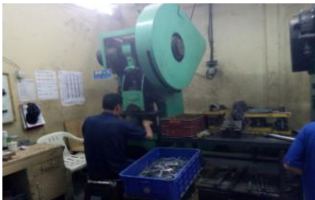
Gambar 4.1.12 Proses Bending (Sumber: PT Nusa Indah Jaya Utama)
