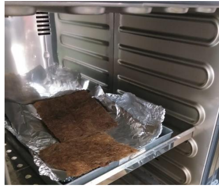
Proses pengeringan serat kelapa
