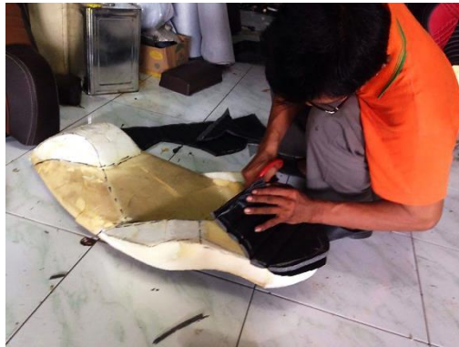
Gambar IV.8 Menggunting dan mencocokkan kulit dengan busa jok
