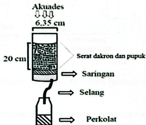
Gambar II.3 Pengujian laju pelepasan nitrogen dengan metode perkolasi (Hamzah dkk., 2019)
