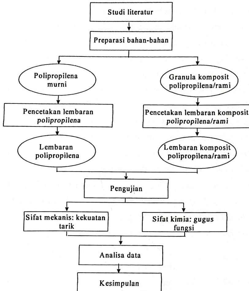
Gambar III. 1 Skema Pembuatan Lembaran Komposit Polipropilena/Serat Rami Pendek.
