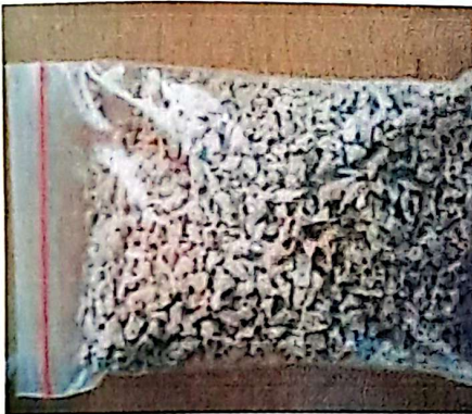
Komposit granula polipropilena/serat rami
