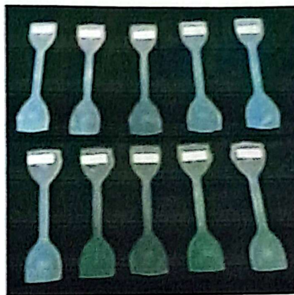
Spesimen dog bone polipropilena mumi
