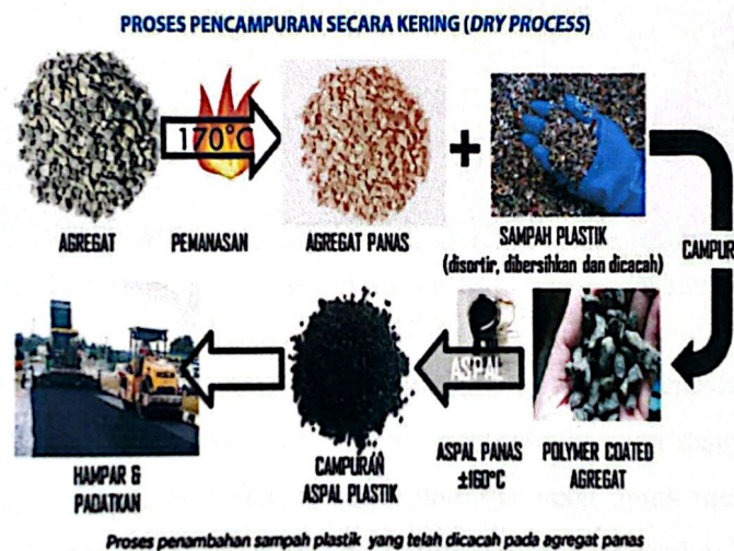
Gambar II.2 Skema Pembuatan Aspal Plastomer
