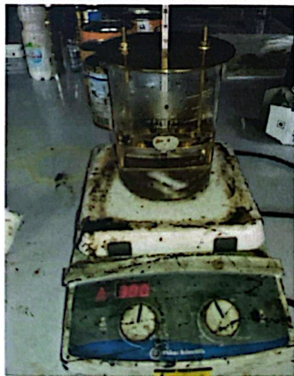
Gambar A.11. Magnetic Stirrer dan Alat Pengujian Titik lembek
