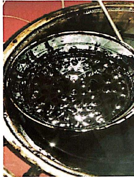
Gambar B.6. Kompon Karet Sebagian Menyatu dengan Aspal
