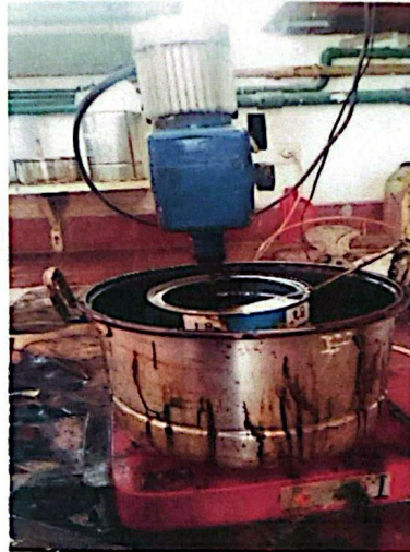
Gambar 1 : Mixer Aspal Karet (Untuk Mengaduk dan Mencampurkan Aspal Penetrasi 60 dengan Lateks Pravulkanisasi dan Trans-Polyoctenamer )
