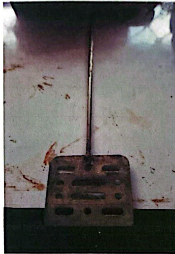
Gambar 3 : Pengaduk Listrik (Membantu Mengaduk Lateks pada Proses Pencampuran Lateks Pravulkanisasi)
