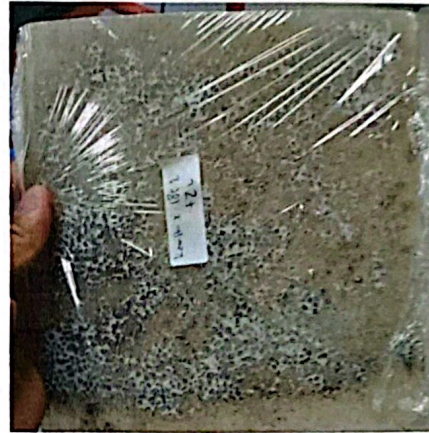
Lembaran Komposit Polipropilena/Zeolit Alam Lampung dengan Persentase Massa Zeolit Alam Lampung 10% dan MAPP 30%; Temperatur Manual Forming Machine 185°C
