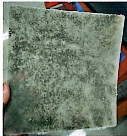
Lembaran Komposit Polipropilena/Zeolit Alam Lampung dengan Persentase Massa Zeolit Alam Lampung 10% dan MAPP 30%; Temperatur Manual Forming Machine 190°C
