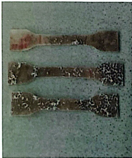
Spesimen Komposit Polipropilena/Zeolit Alam Lampung dengan Persentase Massa Zeolit Alam Lampung 10% dan MAPP 20%; Temperatur Manual Forming Machine 185°C
