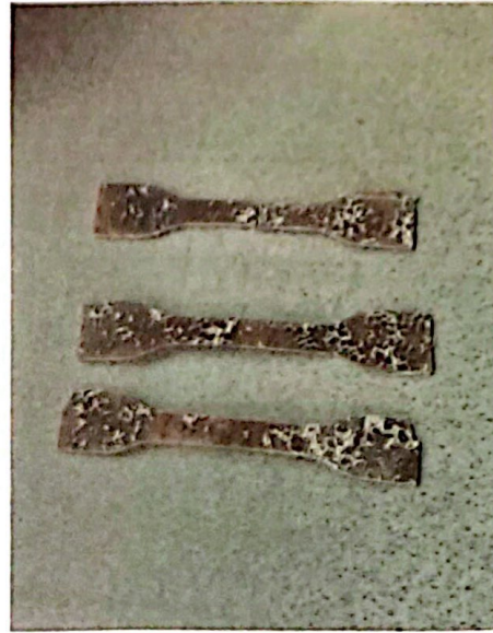
Spesimen Komposit Polipropilena/Zeolit Alam Lampung dengan Persentase Massa Zeolit Alam Lampung 20% dan MAPP 30%; Temperatur Manual Forming Machine 185°C
