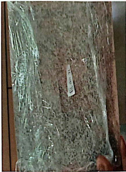
Lembaran Komposit Polipropilena/Zeolit Alam Lampung dengan Persentase Massa Zeolit Alam Lampung 20% dan MAPP 20%; Temperatur Manual Forming Machine 185°C
