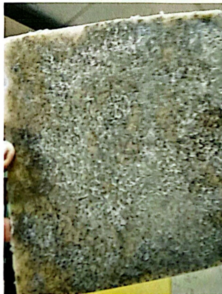
Lembaran Komposit Polipropilena/Zeolit Alam Lampung dengan Persentase Massa Zeolit Alam Lampung 20% dan MAPP 30%; Temperatur Manual Forming Machine 190°C
