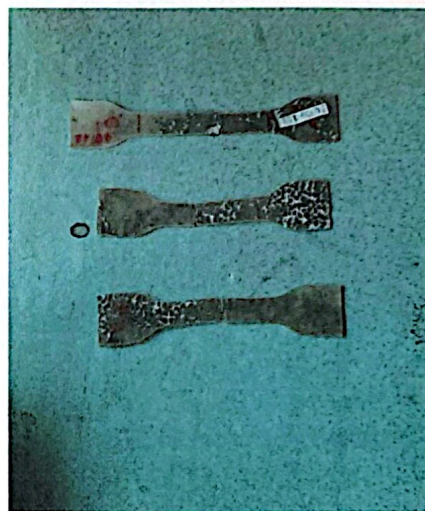
Spesimen Komposit Polipropilena/Zeolit Alam Lampung dengan Persentase Massa Zeolit Alam Lampung 10% dan MAPP 30%; Temperatur Manual Forming Machine 185°C
