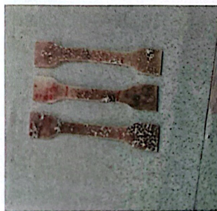
Spesimen Komposit Polipropilena/Zeolit Alam Lampung dengan Persentase Massa Zeolit Alam Lampung 10% dan MAPP 30%; Temperatur Manual Forming Machine 190°C
