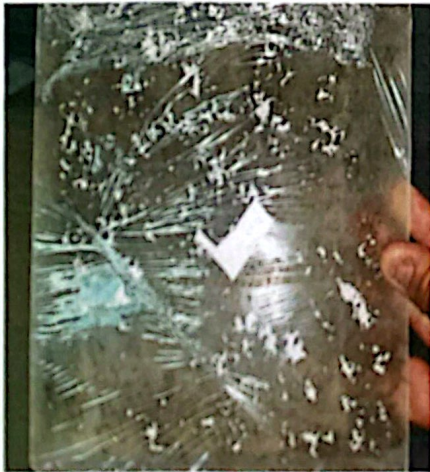
Lembaran Komposit Polipropilena/Zeolit Alam Lampung dengan Persentase Massa Zeolit Alam Lampung 10% dan MAPP 20%; Temperatur Manual Forming Machine 190°C
