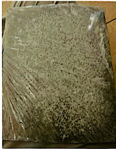
Lembaran Komposit Polipropilena/Zeolit Alam Lampung dengan Persentase Massa Zeolit Alam Lampung 20% dan MAPP 30%; Temperatur Manual Forming Machine 185°C
