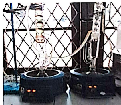
Gambar B.10 Proses distilasi selama 2 jam
