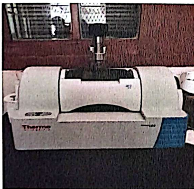
Gambar B.13 Lalu diuji jenis karet dengan alat uji FTIR
