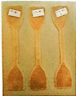
Spesimen Uji Tarik Sampel 3 Komposit serat rami 15%, 180°C
