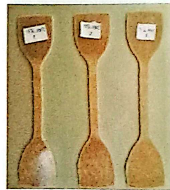
Spesimen Uji Tarik Sampel 4 Komposit serat rami 15%, 190°C
