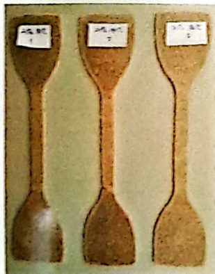
Spesimen Uji Tarik Sampel 5 Komposit serat rami 20%, 180°C
