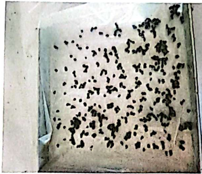
Masterbatch Sesudah Dipotong
