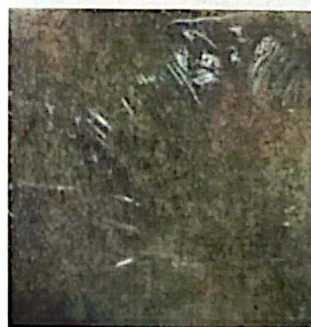
Lembaran Komposit Polipropilena Zeolit 10%wt MAPP 20%wt 190°C
