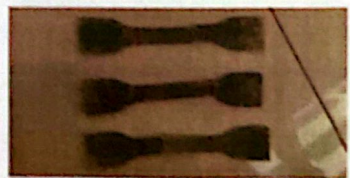
Sampel Komposit Polipropilena Zeolit 20 %wt MAPP 30 %wt 185°C
