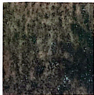
Lembaran Komposit Polipropilena Zeolit 20%wt MAPP 30%wt 185°C
