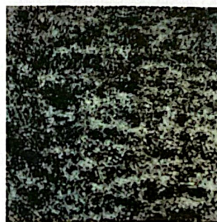
Lembaran Komposit Polipropilena Zeolit 20%wt MAPP 30%wt 190°C
