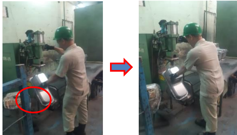
Gambar 5.5 Operator Memasang Oil Pan pada jig (Sumber: PT Cidas Supra Metalindo)
