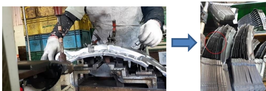
Gambar 5.2 Potensi Peletakan Part dalam Keadaan Kotor (Sumber: PT Cidas Supra Metalindo)
