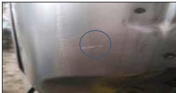
Gambar 4.12. Jenis Cacat Scratch (Sumber: Pengumpulan Data)
