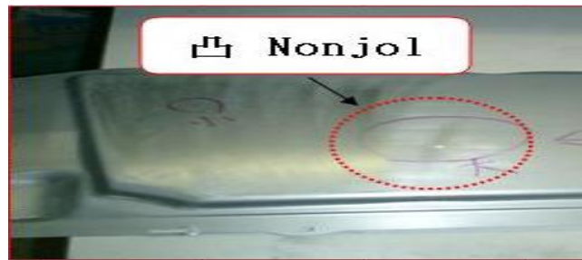
Gambar 4.20 Jenis Cacat Nonjol (Sumber: Pengumpulan Data)
