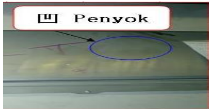
Gambar 4.19 Jenis Cacat Penyok
