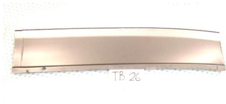
Bukti Perbaikan Cacat Penyok Colt T120SS
