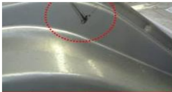
Gambar 4.21 Jenis Cacat Bolong (Sumber: Pengumpulan Data)
