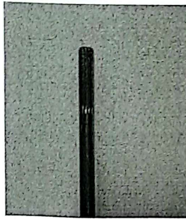
Gambar 4.14 Shaft Kick yang sudah melalui proses hobbing (Sumber: PT Galih Ayom Paramesti)
