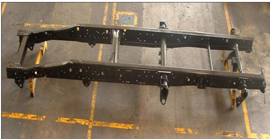
Gambar IV.3 Frame Chassis (Sumber : PT Gemala Kempa Daya, 2018)
