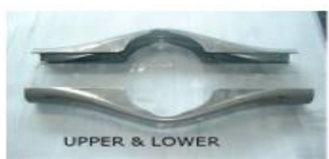
Gambar IV.4 Kategori Produk Pressed Part Housing Rear Axle (Sumber : PT Gemala Kempa Daya, 2018)
