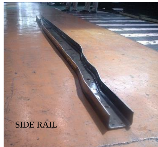
Gambar 4.4 Komponen Utama Frame Chassis (Sumber: PT Gemala Kempa Daya)
