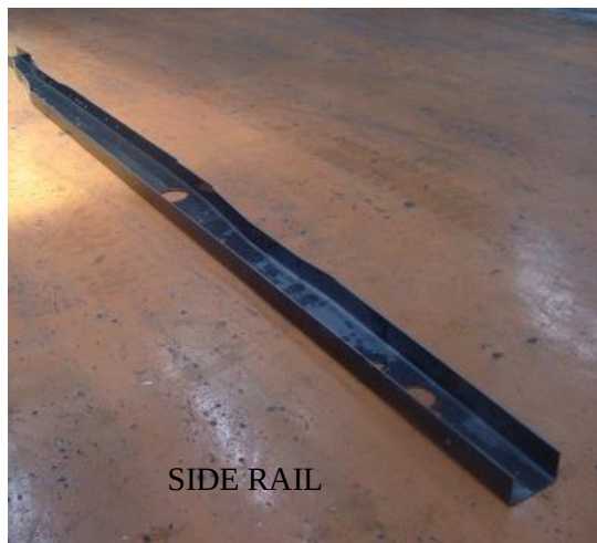
Gambar 4.4 Komponen Utama Frame Chassis (Sumber: PT Gemala Kempa Daya)
