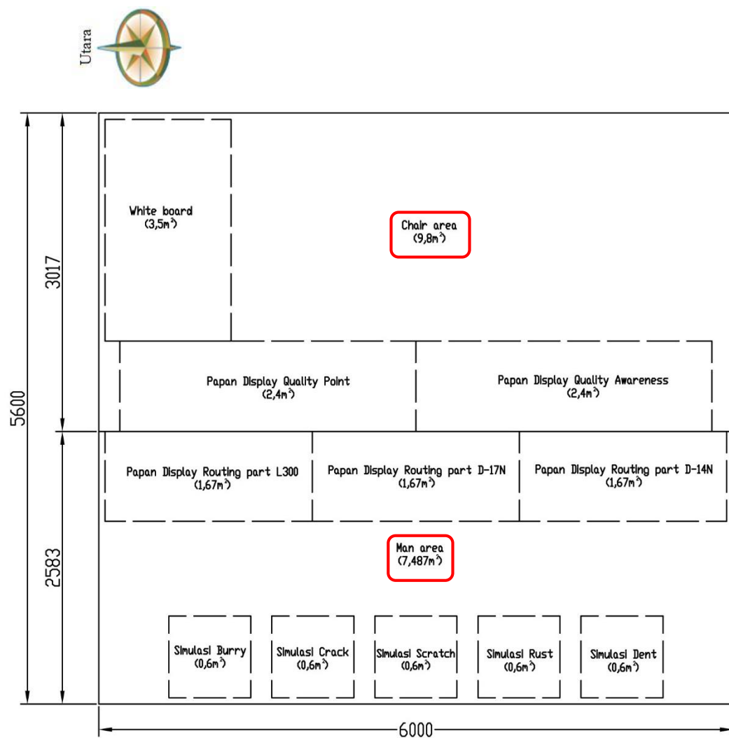
Gbr 5.5 Analisis block plan berdasarkan Space relationship diagram dan luas lantai yang tersedia skala 1:50 (Sumber : Analisis dan Pembahasan)
