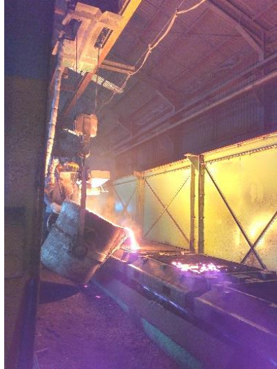
Gambar 4.10 Proses Pouring (Sumber: PT Bakrie Autoparts)
