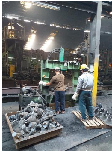
Gambar 4.14 Proses Pematah Casting (Sumber: PT Bakrie Autoparts)
