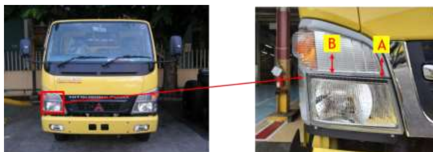
Gambar 4. 7. Cacat Gap pada Produk Head Lamp dan Combination Lamp
