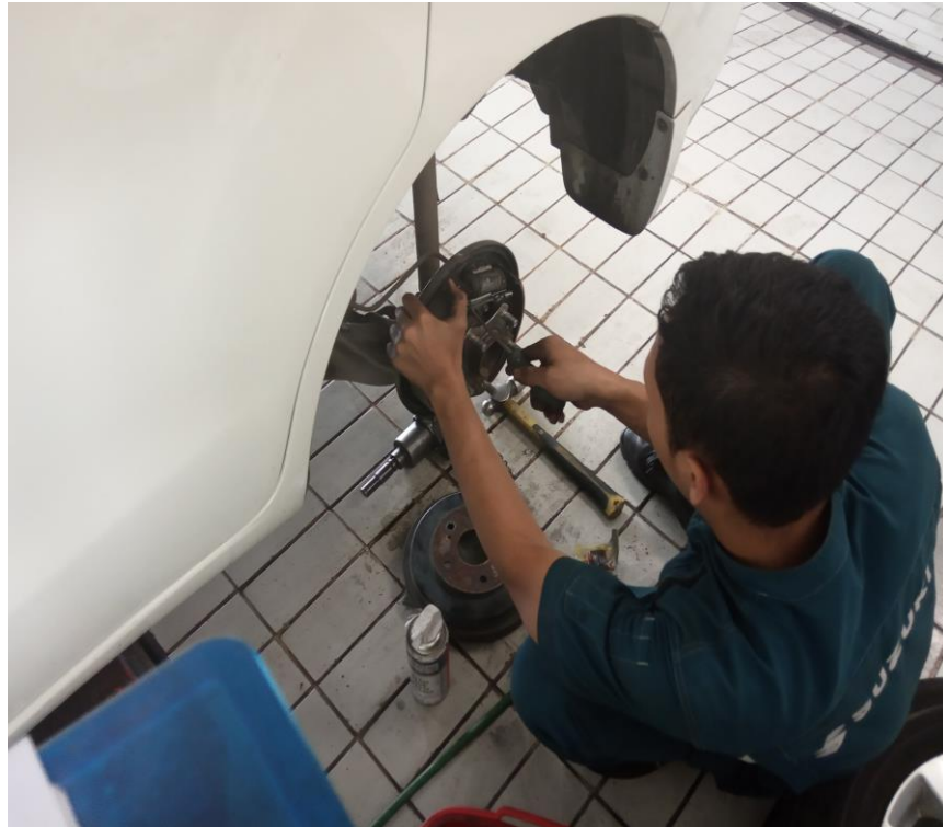
Gambar 5.2 Membersihkan dan Memeriksa Rem Posisi Jongkok Sumber: PT Sejahtera Buana Trada
