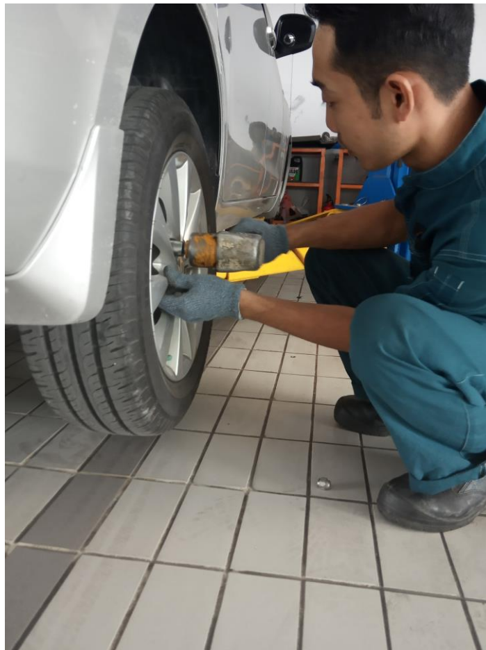
Gambar 5.1 Posisi Membuka Ban Jongkok Sumber: PT Sejahtera Buana Trada
