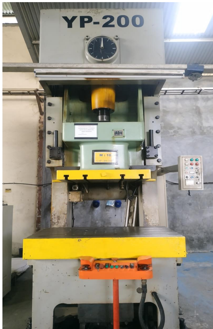
Gambar 4.5 Mesin Press 200 Ton (Sumber: PT Nusa Indah Jaya Utama)
