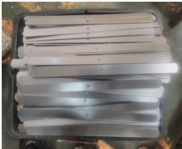
Gambar 4. 15. Hasil Blank-Piercing Plate Triangel (Sumber: PT Hadeka Primantara)
