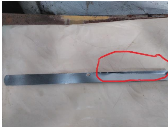
Gambar 4. 23. Cacat Dent (Sumber: PT Hadeka Primantara)
