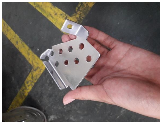
Gambar 4. 13 Hasil Proses Piercing (Sumber: PT Hadeka Primantara)
