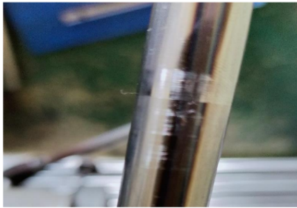
Gambar 4.19. Cacat scratch Sumber : PT Madya Puji Rahayu
