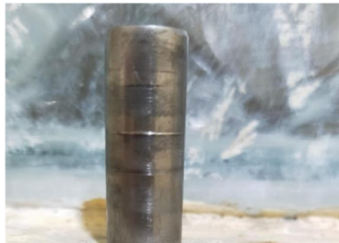
Gambar 4. 21. Cacat gouge Sumber : PT Madya Puji Rahayu
