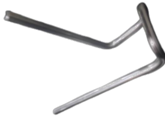
Gambar 4. 15. Proses bending 5 produk headrest Sumber : PT Madya Puji Rahayu
