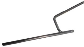
Gambar 4. 14. Proses bending 4 produk headrest Sumber : PT Madya Puji Rahayu
