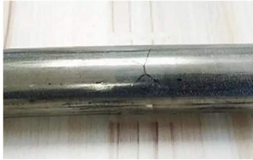
Gambar 4. 22. Cacat crack Sumber : PT Madya Puji Rahayu
