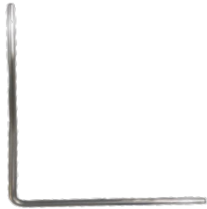
Gambar 4. 10. Proses bending 1 produk headrest Sumber : PT Madya Puji Rahayu
