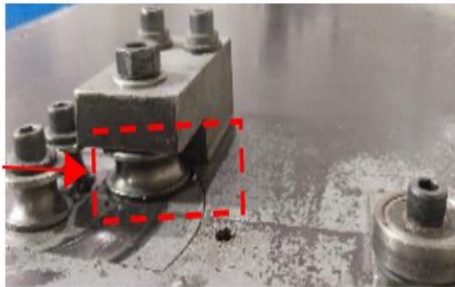
Gambar 5. 2. Roller mesin bending sudah aus Sumber : Pengolahan data (2025)
