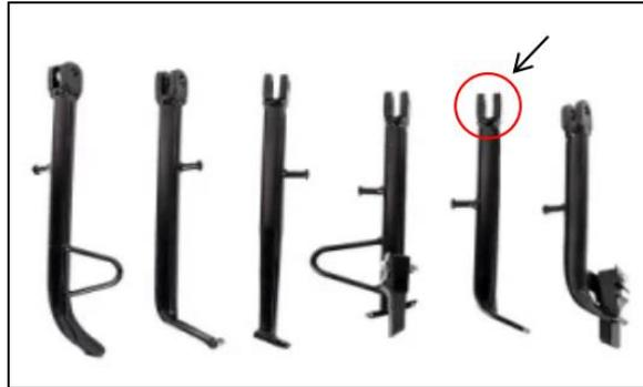
Gambar 2. 1 Posisi *Bracket Stand Side*
