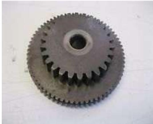
Gambar 4.1. Bentuk *Gear Comp Starter Reduction*
