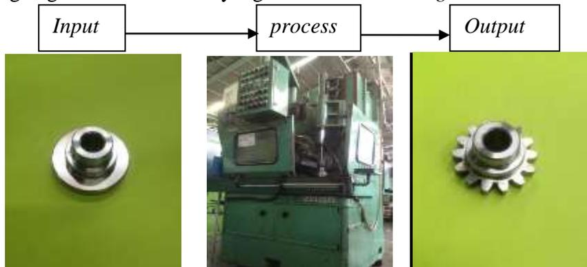
Gambar 4.11. Proses *Hobbing Gear B*
