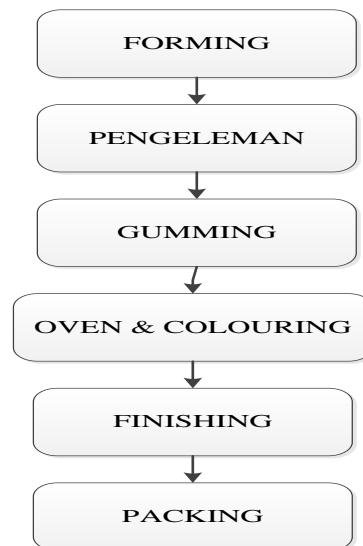
Gambar 4.8 Alur Proses Produk Genteng Pasir
